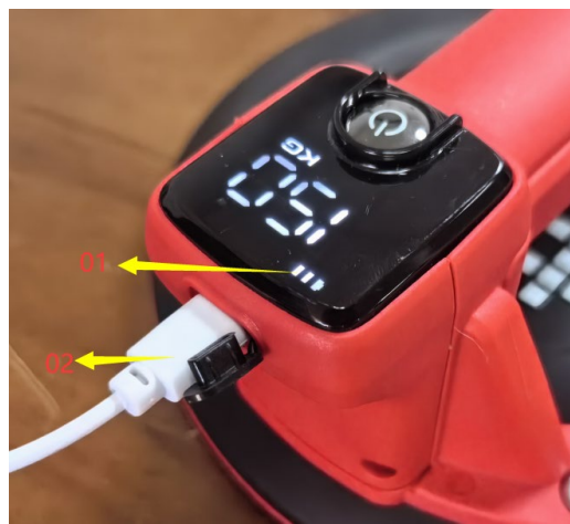
01 batter power display 02 USB typ C cabel
