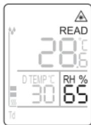
Den relative luftfuktigheten beregnes og vises automatisk under målingen.
