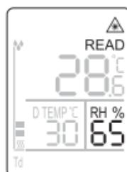
Відносна вологість повітря автоматично визначається та показується під час вимірювання.
