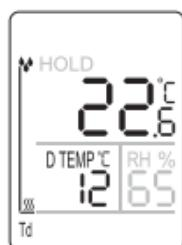
Infraraudonųjų spindulių temperatūra  $\geq 2.5$  °C už rasos taško temperatūrą: skalė be nukrypimo. Kondensatas nesusidaro.
