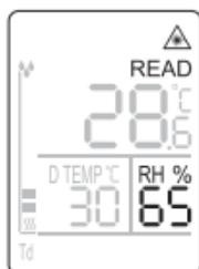
Η σχετική υγρασία αέρα μετράται και εμφανίζεται αυτομάτως κατά τη διαδικασία μέτρησης.
