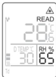
Определение и индикация относительной влажности воздуха осуществляются автоматически во время процесса измерения.
