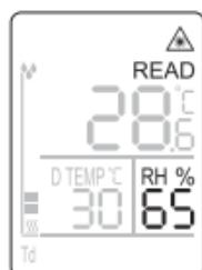
Относителната влажност на въздуха се установява и посочва автоматично по време на процеса на измерване.
