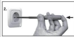
Uchopte izolovanou rukojet' zkoušecky napětí podle obrázku. Umístejte testovací sondu 1 do elektrického obvodu a vždy dodržujte příslušný rozsah napětí. Dotkněte se polu 3 holým prstem a pozorujte doutnavku 2:
